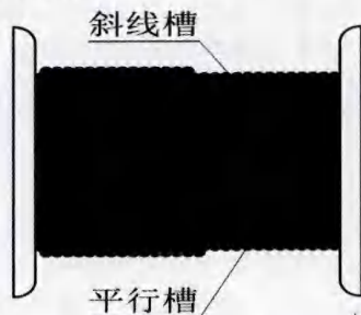
图3 光面卷筒缆绳缠绕示意图
